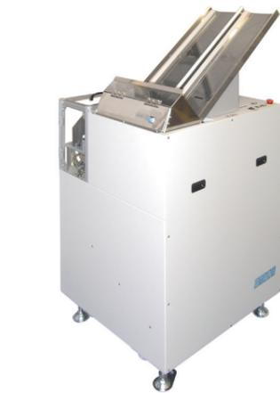
2 台の CM-20DI/DIS とターン・ユニットを使えば最初の CM-20DI/DIS でディスクを挿入したケースを 180 度回転させてコンベア下流の次の CM-20DI/DIS で 2 枚目のディスクを挿入できます。また、挿入位置を移動させるオーバーラップ・ユニットと CM-20DI/DIS を追加すれば 4 枚組みケースまで対応可能です。
